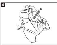
Place the Acerbis fuel tank (A) on the bike. Install the original screws (F) and (G). Posizionare il serbatoio Acerbis (A) sulla moto. Riavvitare la vite del serbatoio (G) le viti della sella e dei fianchetti (F).
